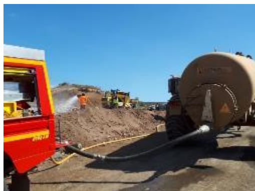
Figure 16 : Véhicule de Première Intervention (VPI) alimenté par la tonne à eau et le tracteur
