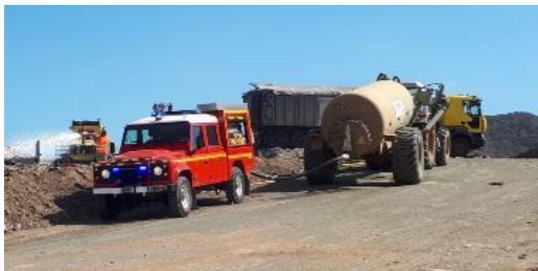
Figure 16 : Véhicule de Première Intervention (VPI) alimenté par la tonne à eau et le tracteur
