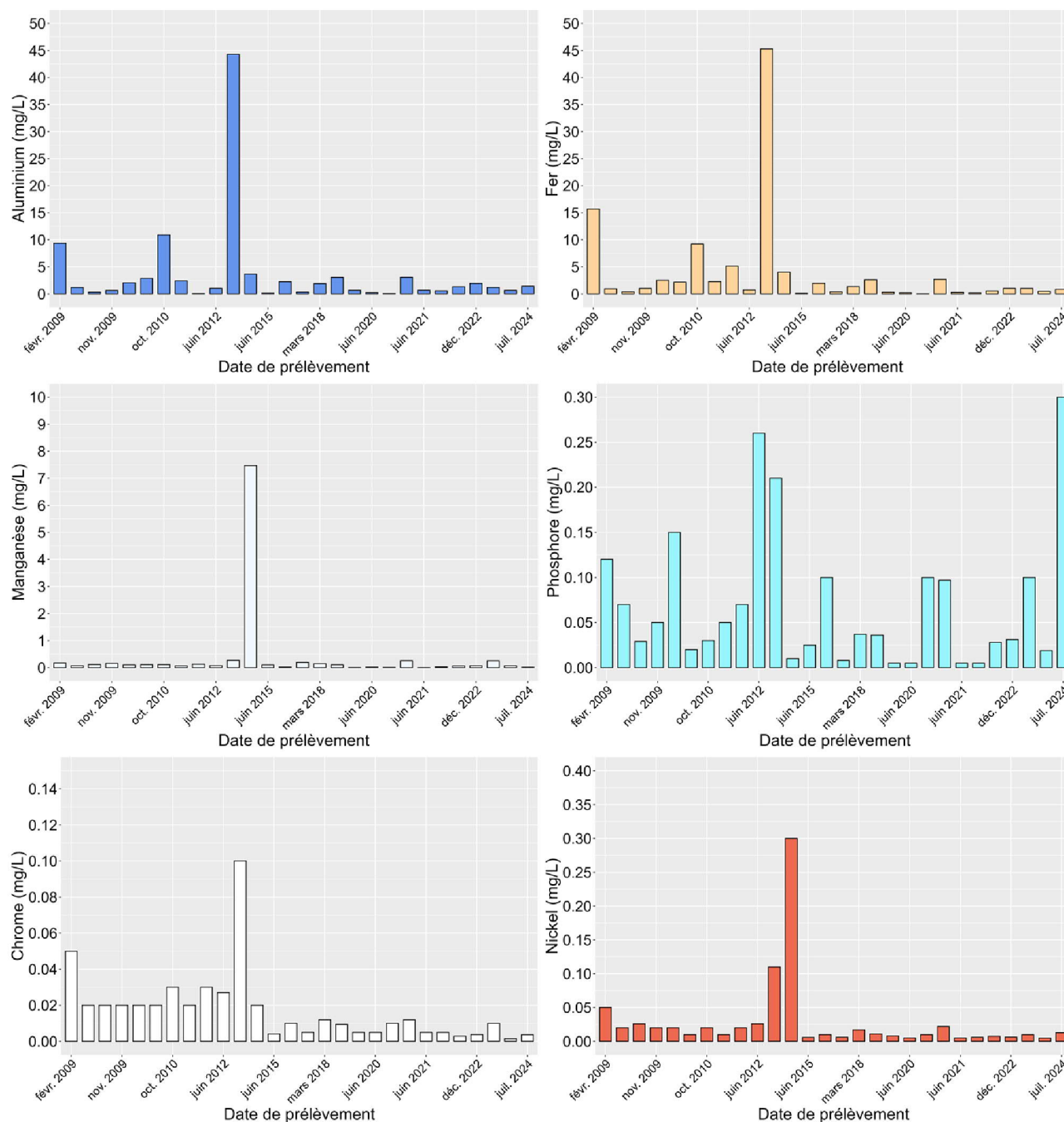
Figure 8 : Evolution des concentrations en éléments métalliques dans les eaux pluviales de l'ISD de Gadji – BG2 (seuil de l'arrêt pour le phosphore à 10 mg/L).
