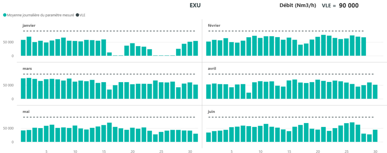
Figure 129 : Suivi du débit volumique horaire à la cheminée EXU
