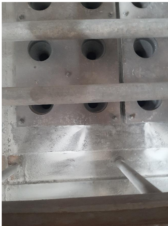
Figure 3 : Ouverture du capot supérieur des filtres et détection d'une bougie cassée
