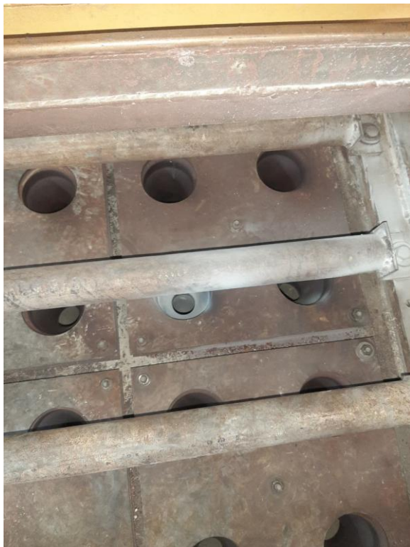
Figure 3 : Ouverture du capot supérieur des filtres et détection d'une bougie cassée
