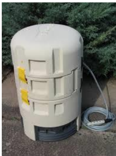
Préleveur réfrigéré avec crépine
