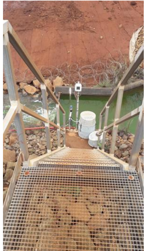
Figure 38 : Préleveur automatique installé sur le drain 4R8
