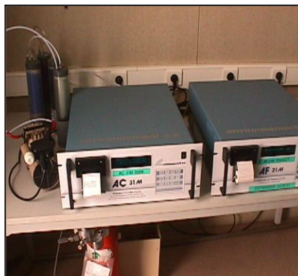
Figure 2 : Analyseurs SO 2 et NO 2 et analyseur de poussières
