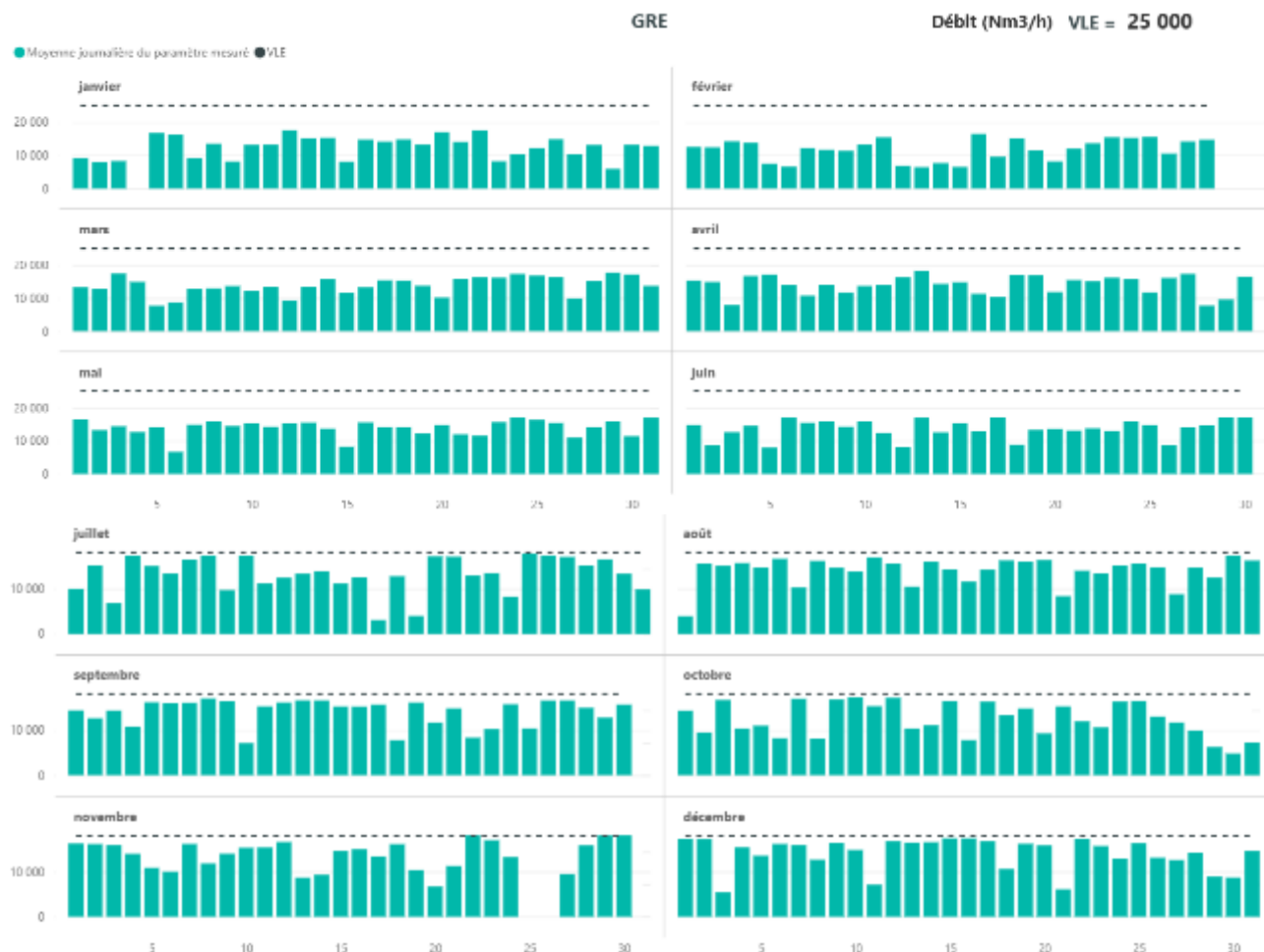
Figure 149 : Suivi du débit volumique horaire à la cheminée GRE
