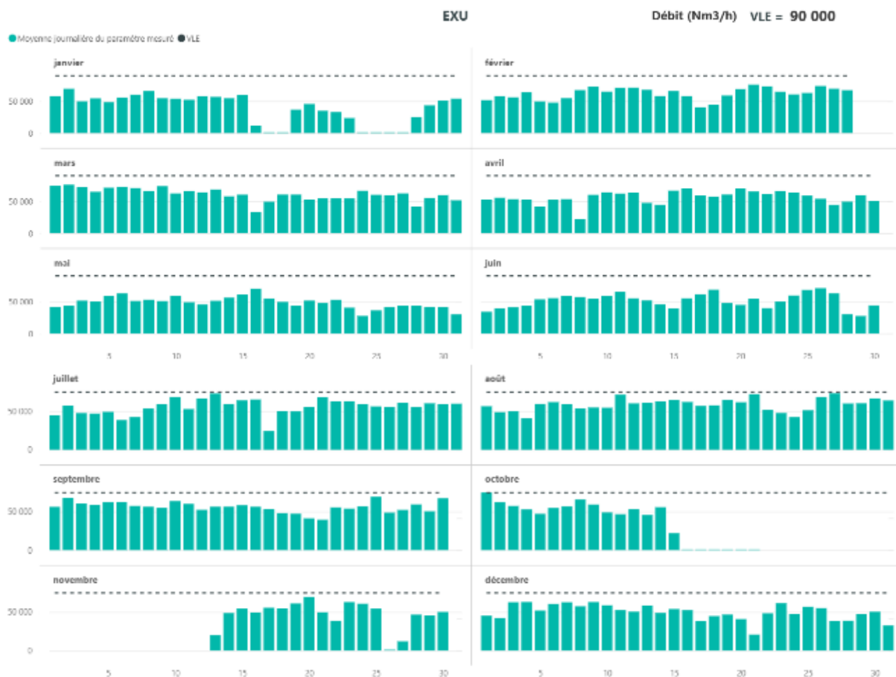
Figure 137 : Suivi du débit volumique horaire à la cheminée EXU
