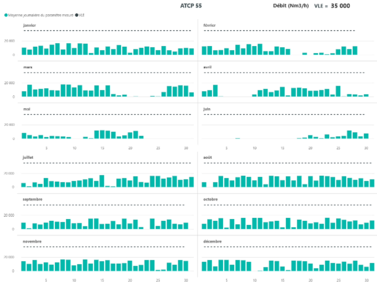
Figure 122 : Suivi du débit volumique horaire à la cheminée de l'atelier de broyage de charbon (ATCP)
