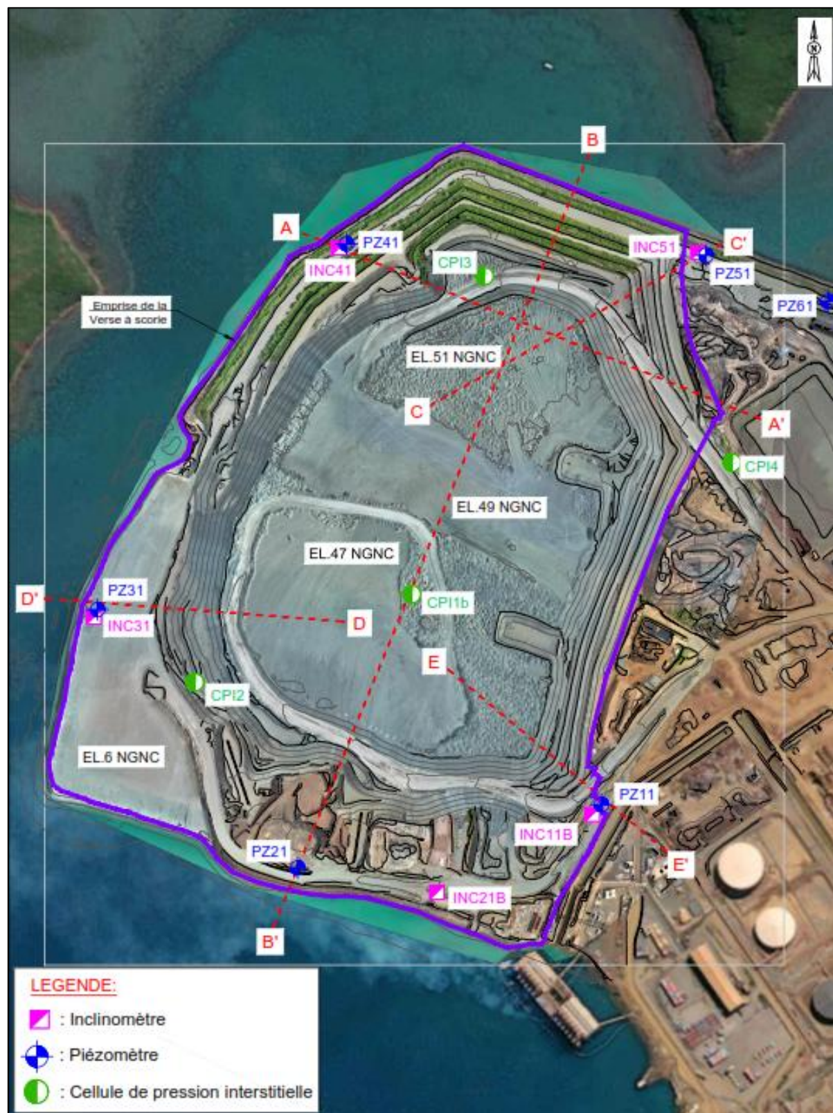
Figure 8 : Implantation du dispositif d'instrumentation de la verse à scories en décembre 2025
