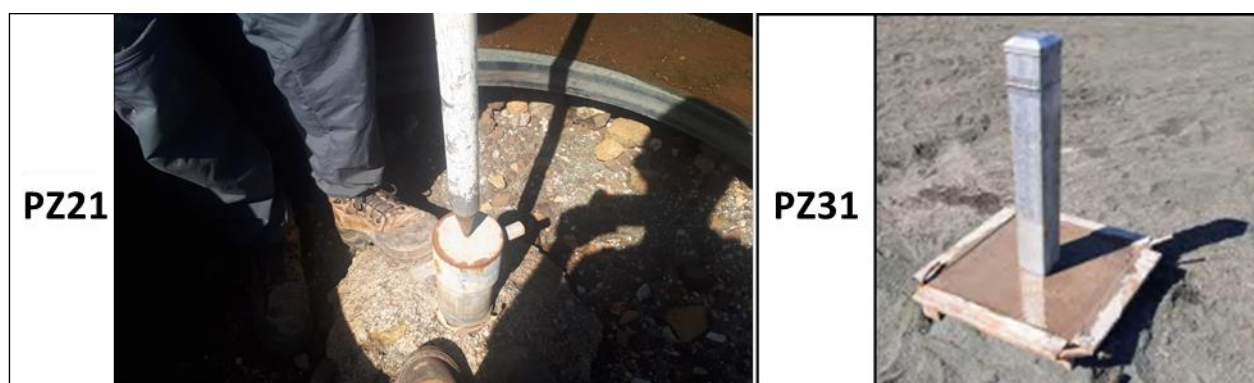
Figure 1 : Points de repère altimétrique du piézomètre.
