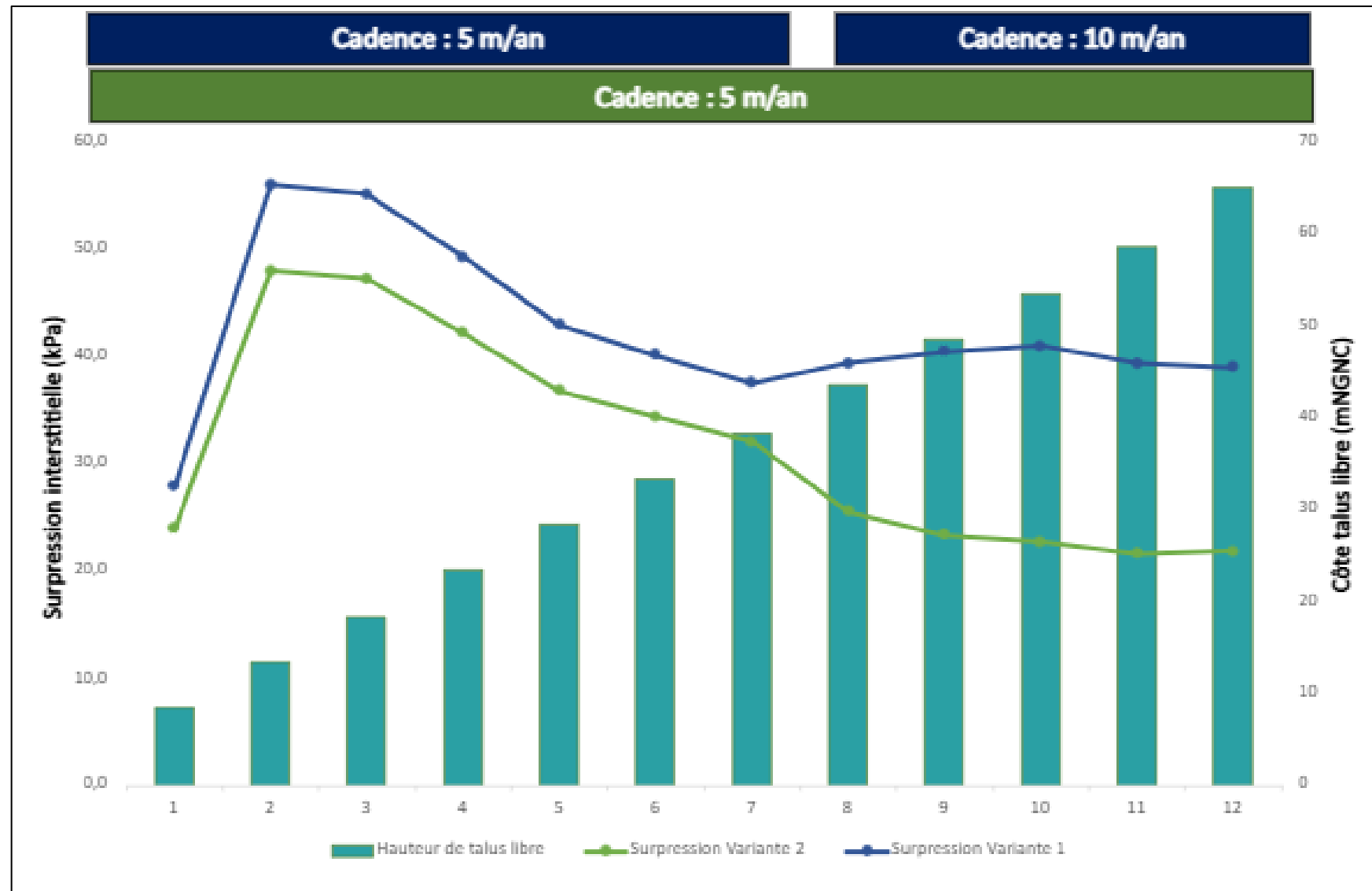
Figure 20. Evolution des surpressions interstitielles en fonction des variantes des cadences
