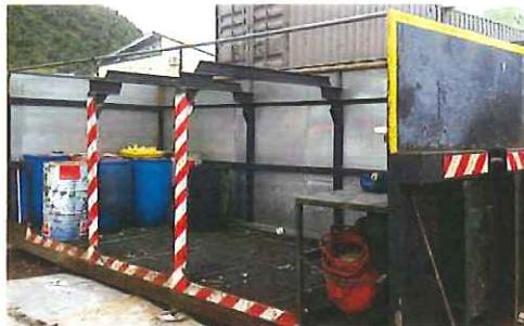
La station de dépollution est mobile. Elle est spécialement adaptée pour être positionnée sur un camion équipé d'un système amplirol tel que notre Poids Lourd. Ce système est étudié pour effectuer des opérations de dépollution directement sur les sites de collecte avant le transport. L'ensemble du plancher en caillebotis de la station est en rétention. Et possède une contenance de 12m<sup>3</sup>.
