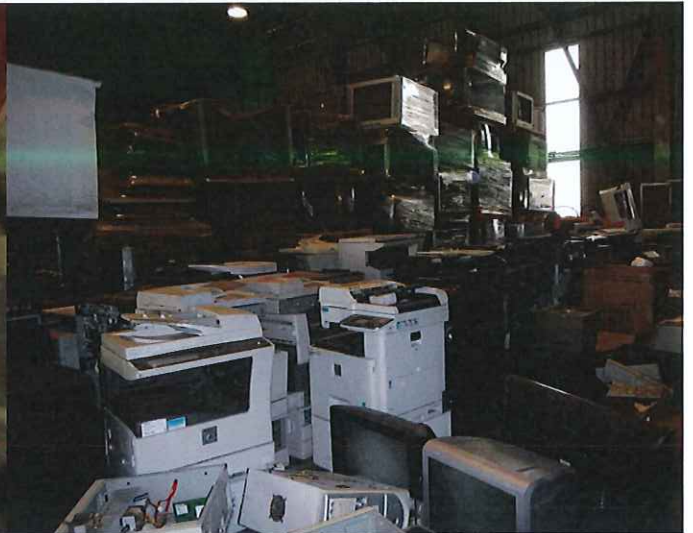
Photo 22 : Vue d'ensemble du dock de stockage avec hauteur maximale de stockage non respectée.
