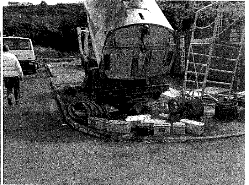
Photo 12 : Batteries stockées sans bac de rétention et exposées aux eaux de pluies
