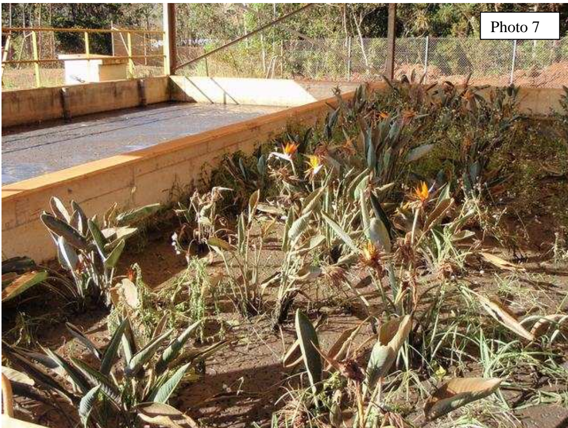
Photos 6 et 7 : Lits de séchage sur lesquels sont testées quelques espèces végétales (photo 6 : Flagellaria neocaledonica ; photo 7 : Strelitzia reginae ) potentiellement aptes à se substituer au roseau Phragmites australis , classé envahissant. Ces lits sont envahis de mauvaises herbes.
