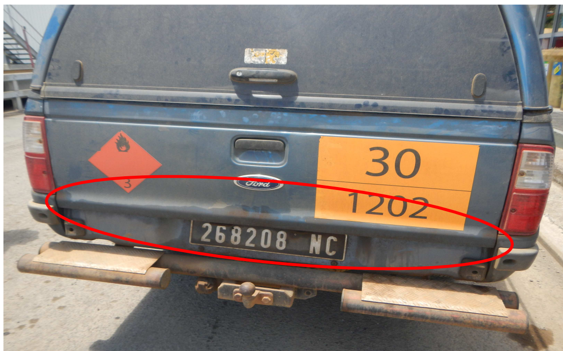
Photo 13 : absence de rétention au niveau de la benne du véhicule de transport de gazole
