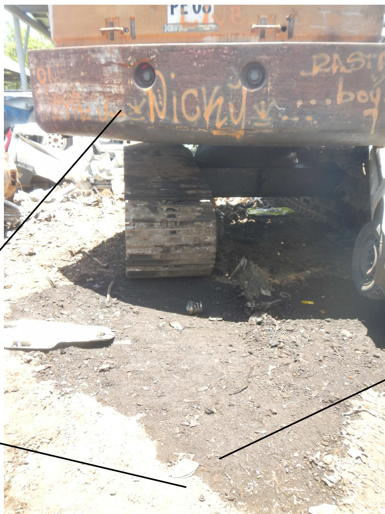
Photo 8 : pollution du sol générée par une fuite d'huile au niveau de la pelle hydraulique
