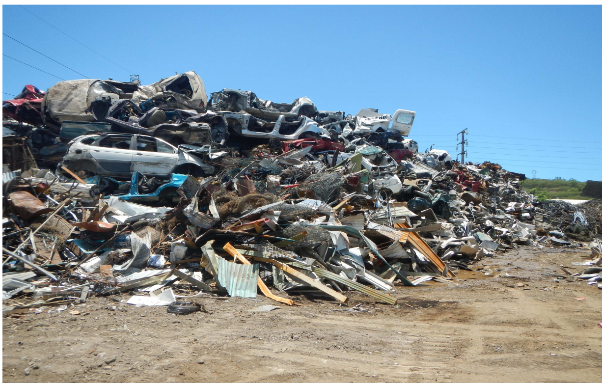
Photo 2 : non-respect du nombre de niveaux d'empilement de carcasses de véhicule (maximum 2 niveaux)
