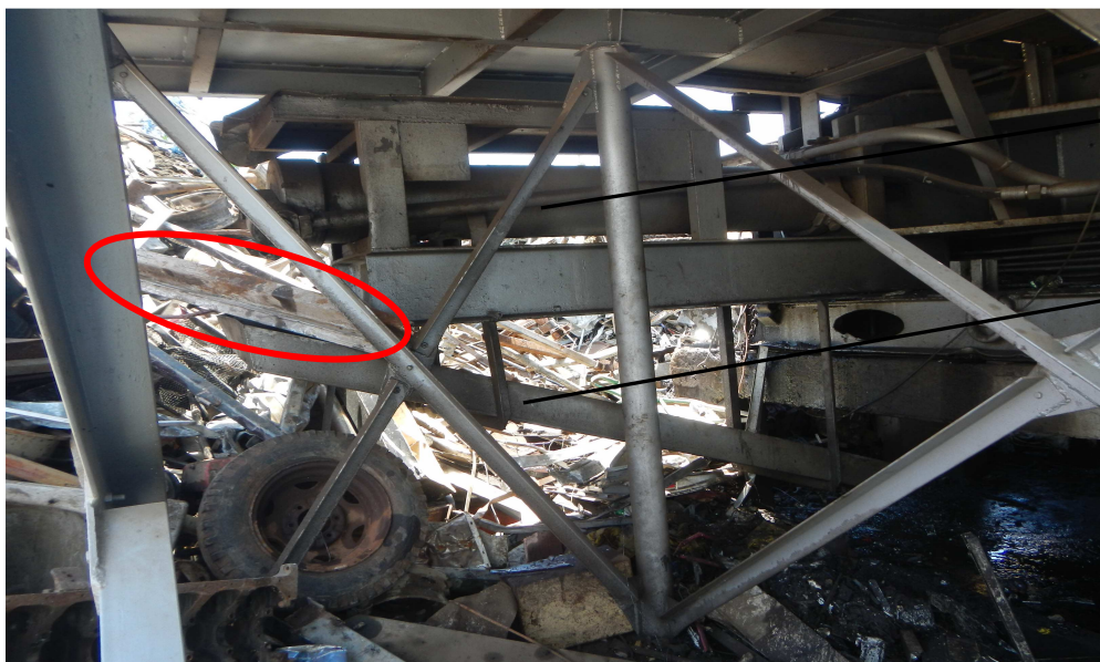
Photo 3 : rétention du vérin de la presse et déchets accumulés à la périphérie de la presse et sous la cabine de pilotage
