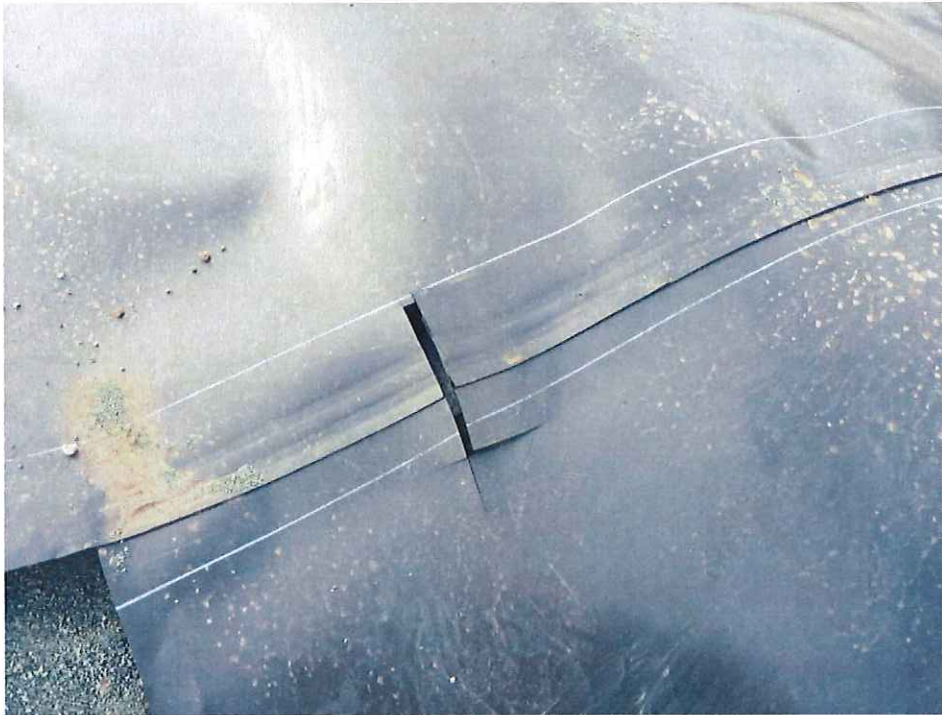
Prise d'échantillon de contrôle destructif des soudures (doubles soudures à canal central)
