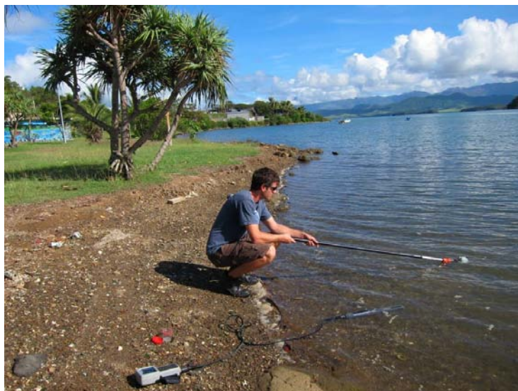
Figure 6 : Prélèvement et mesure in-situ à l'aide de la sonde
