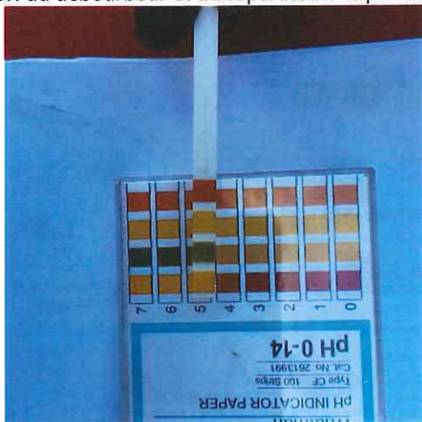
Mesure pH à l'intérieur du séparateur à hydrocarbures
