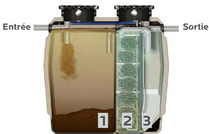
Illustration 19: Vue en coupe du réacteur Oxyfix®
