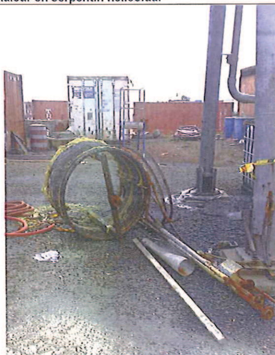
Photo 9 : ancien échangeur de chaleur en serpentín hélicoïdal
