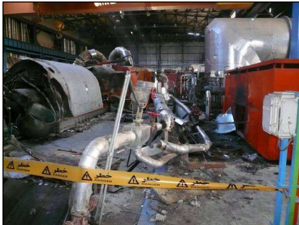
ACCOUPLEMENT AYANT PERCUTE LE GENERATEUR DE VAPEUR
