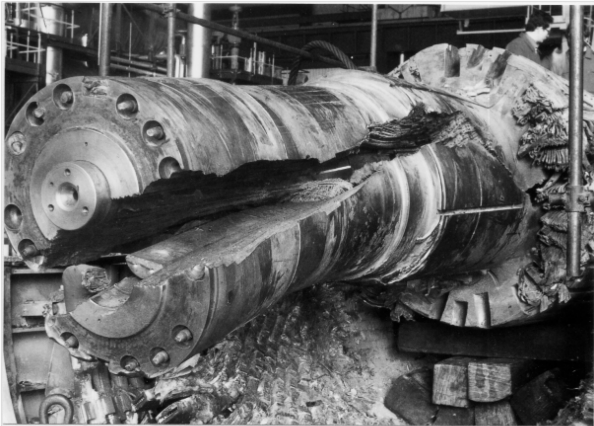
Rotor de turbine à vapeur ayant fait l'objet d'une fracture fragile au niveau de l'alésage de l'arbre.
