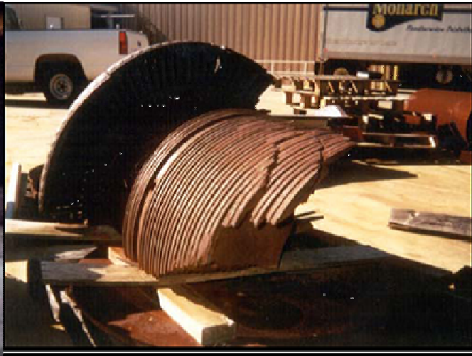
Fragment du rotor MP / BP de Gallatin 2. (USA)
