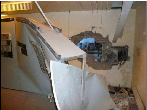
ACCOUPLEMENT AYANT PERCUTE LE GENERATEUR DE VAPEUR
