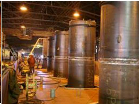
Figure 14 - Dessus d'un four et électrodes
