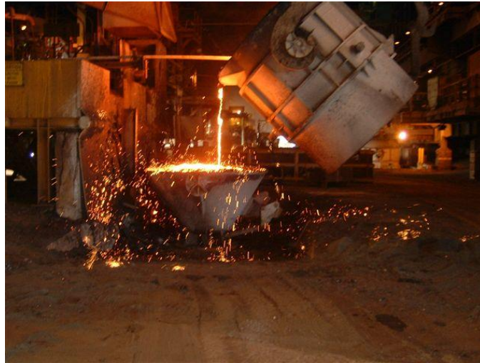
Figure 19 - Décrassage de la scorie de soufflage
