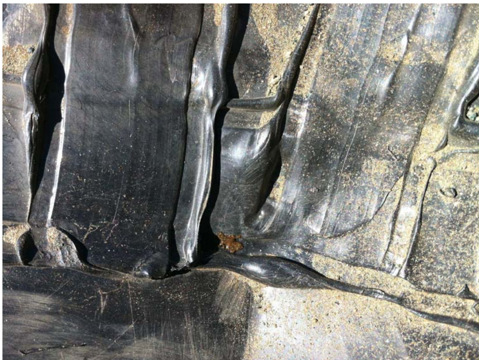
Défaut d'étanchéité d'une extrusion détectée au balai électrique sur la géomembrane supérieure
