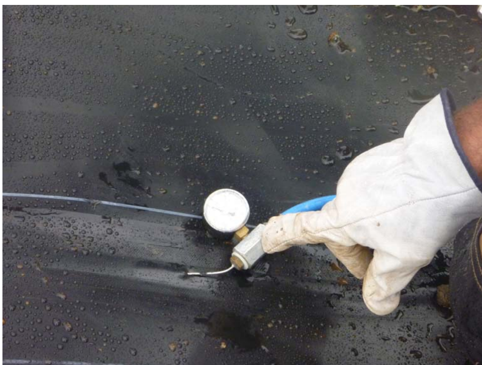
Contrôle des soudures double canal à l'air comprimé
