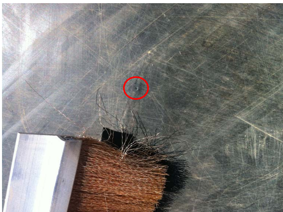
Microfuite détectée au balai électrique sur géomembrane supérieure
