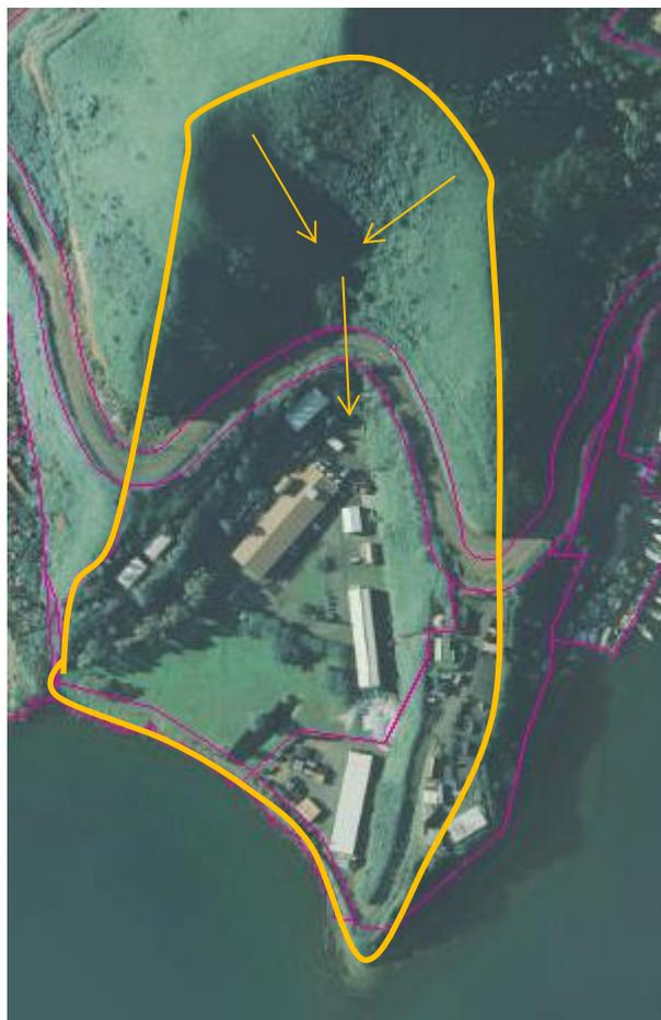
**Figure 6 : Emprise du bassin versant et écoulements préférentiels des eaux pluviales**
