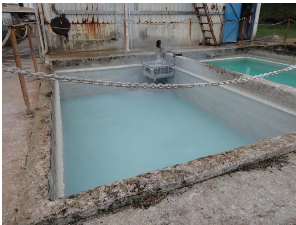
Photo n°6 : Bassins de décantation du lait de chaux
