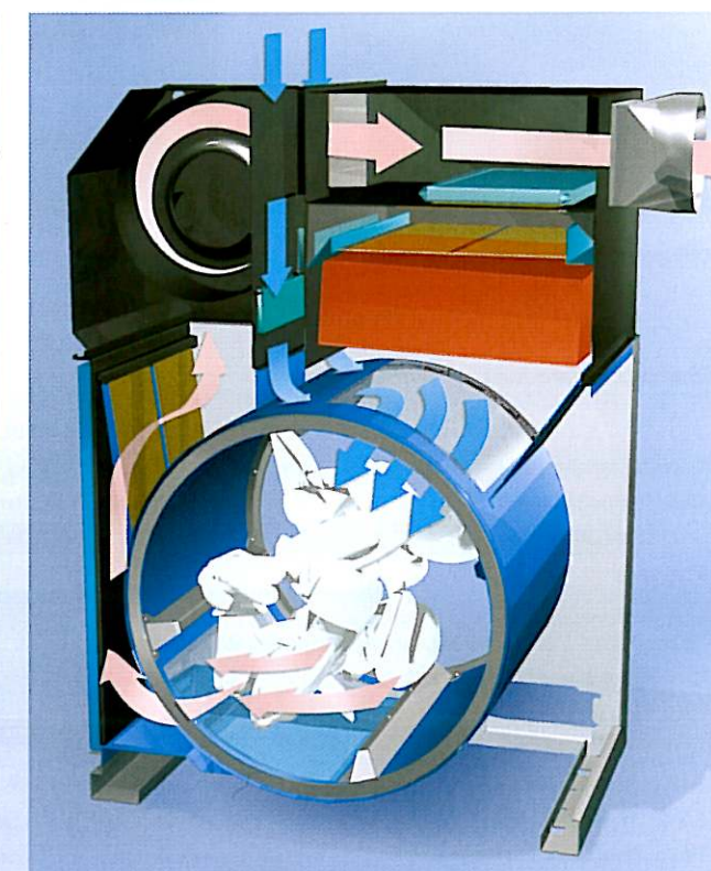
Flux d'air pour le chauffage vapeur.
