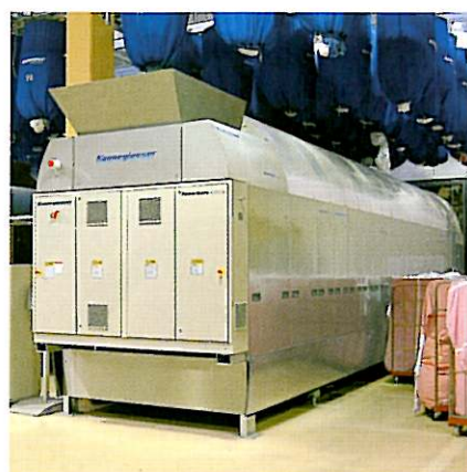
Tunnel de lavage
