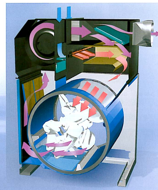
Flux d'air pour le chauffage au gaz.
