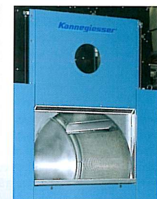
Porte de chargement D 60. Pour permettre un chargement et un déchargement rapides, la machine est équipée de larges portes.
