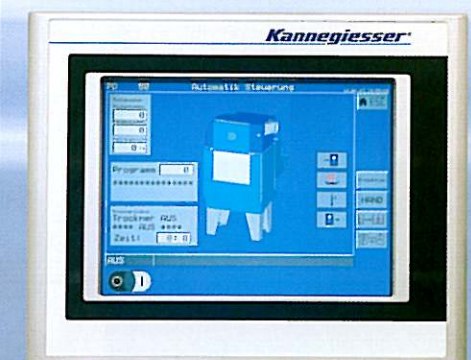
Le pupitre de contrôle par écran tactile fournit à l'opérateur une information opérationnelle ainsi qu'une aide à la recherche de pannes. Cette option permet d'augmenter l'efficacité de la machine. Une connexion à un réseau permet d'étendre les possibilités du système.
