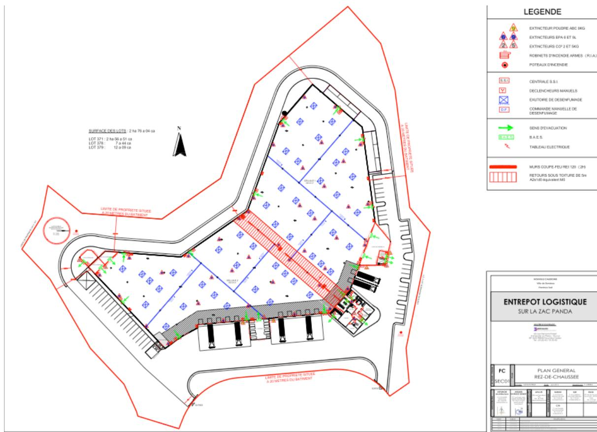
Figure 5 : plan de sécurité et d'évacuation
