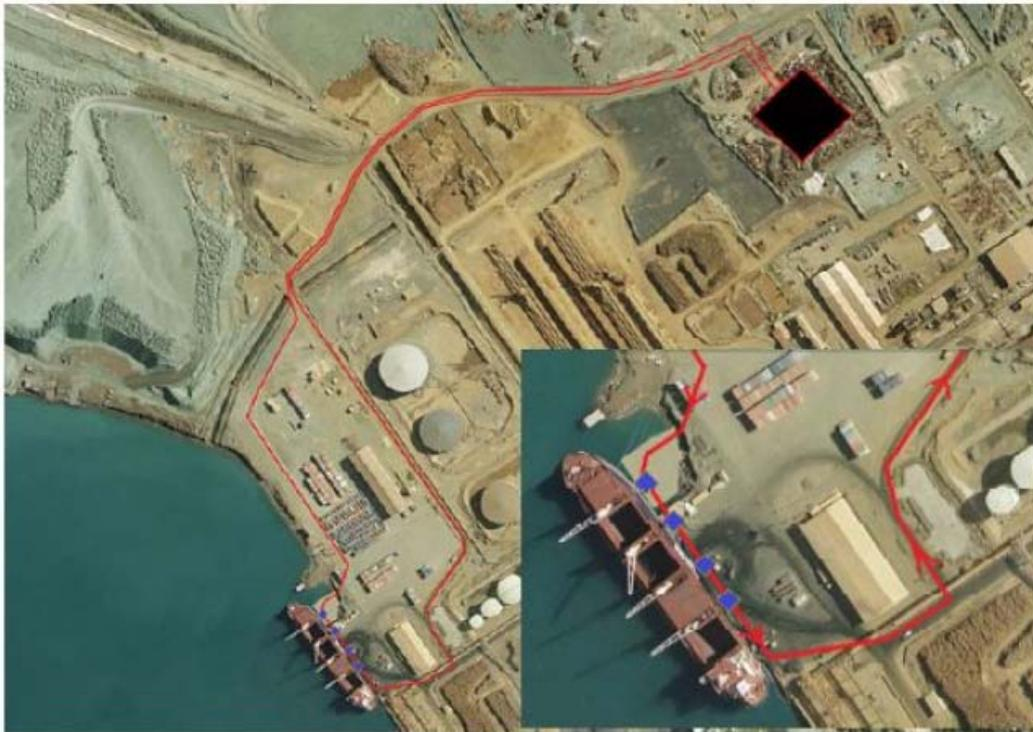
**Figure 1 : Vue aérienne du circuit de fourniture et de stockage du charbon**
