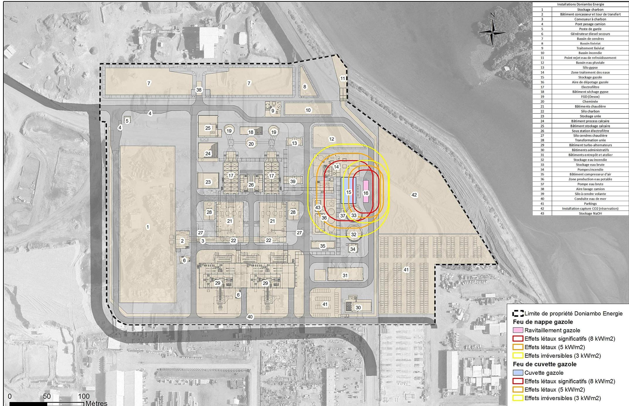
Distances d'effets scénarios (Scénario n°85 explosion bac gazole et scénario n°43 explosion ballon vapeur chaudière)
