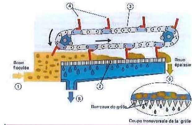
La boue, préalablement floculée dans un mélangeur statique est déposée sur un champ horizontal de grilles fines. Les flocs restent sur la grille où ils sont progressivement épaissis et dirigés vers la sortie au moyen de lames racleuses en caoutchouc tractées par un entraînement à chaînes.
