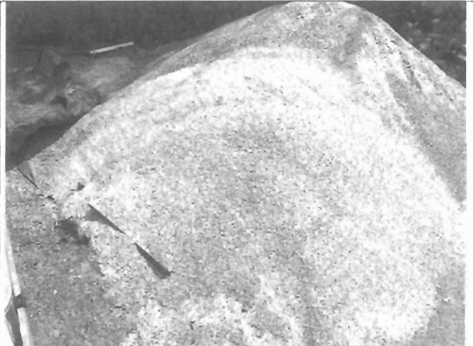
Photo 2 : Stockage de verre broyé au sol sur une bâche
