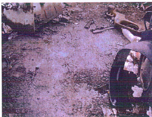
Image 13 – Stockage sauvage à l'angle nord du site : traces de pollution aux hydrocarbures
