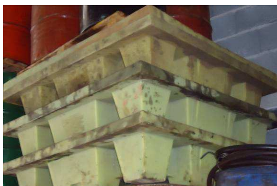
Figure 8. Bacs de rétention utilisés lors du stockage des fûts.
