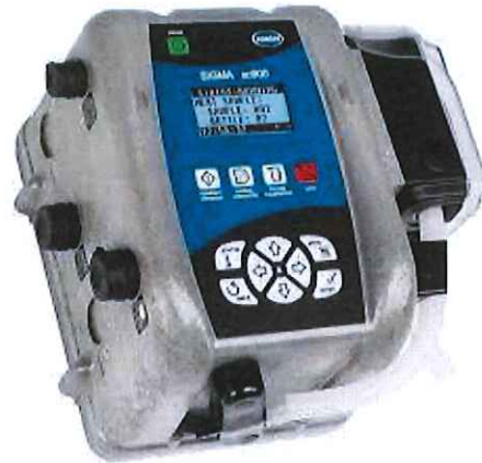
Tête de prélèvement avec écran de programmation
