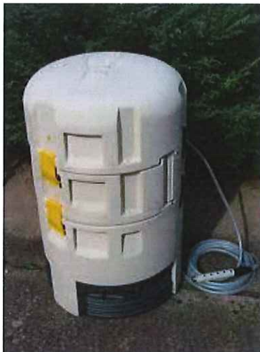
Préleveur réfrigéré avec crépine
