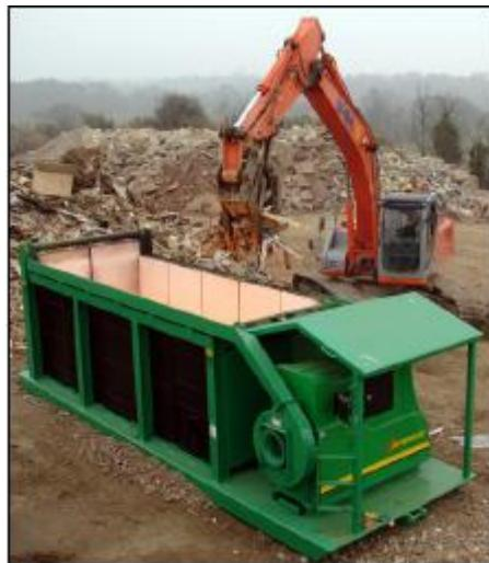
**Figure 4: Alimentation d'un Combusteur (AirBurners)**
