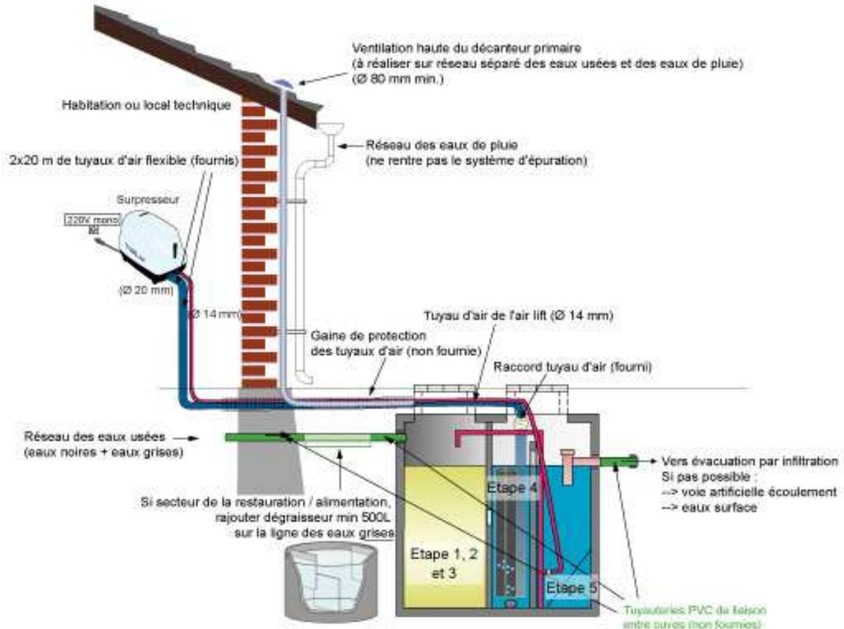
Notre station d'épuration est composée de trois compartiments réalisant 5 étapes de traitement.
