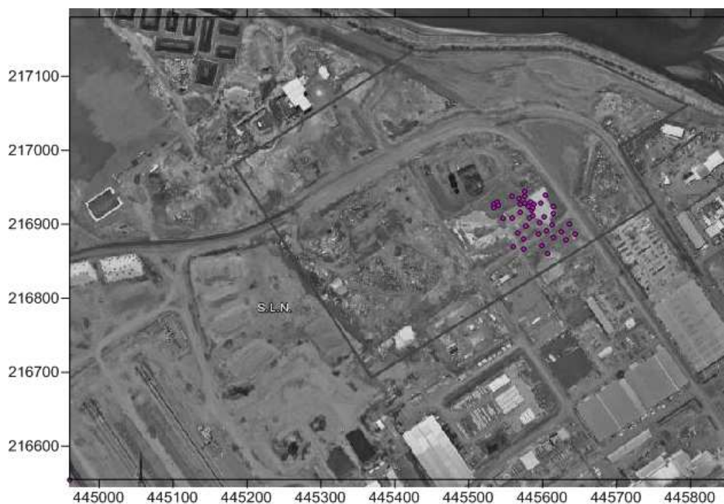
Troisième phase d'investigations (septembre 2014) : 41 sondages (séries 100 et 200) à la tarière, jusqu'à cinq analyses par sondage
