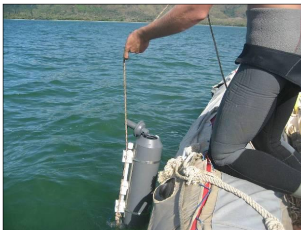
Figure 2 : Echantillonneur 5 litres pour les prélèvements d'eau
