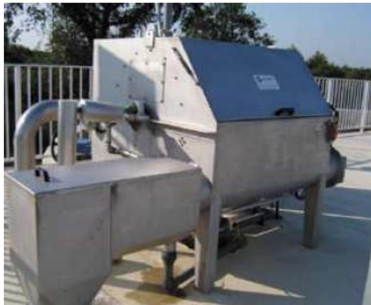
*Installation extérieure d'un tamis avec compacteur intégré*
