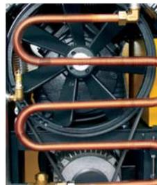
Refroidissement efficace grâce au tuyau de refroidissement final d'air comprimé en cuivre
