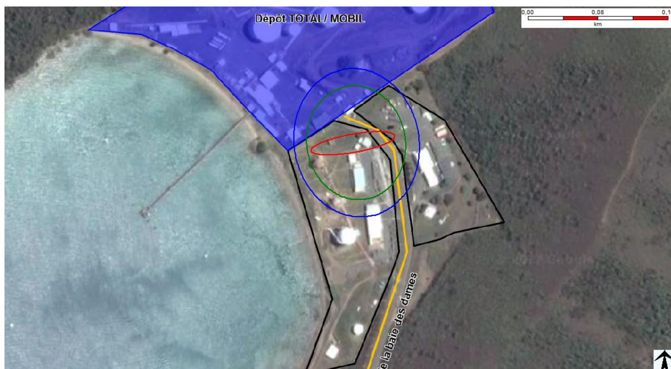
Figure 35 : Cartographie des zones d'effets thermiques du jet enflammé pour la perte de confinement du flexible de déchargement navire
