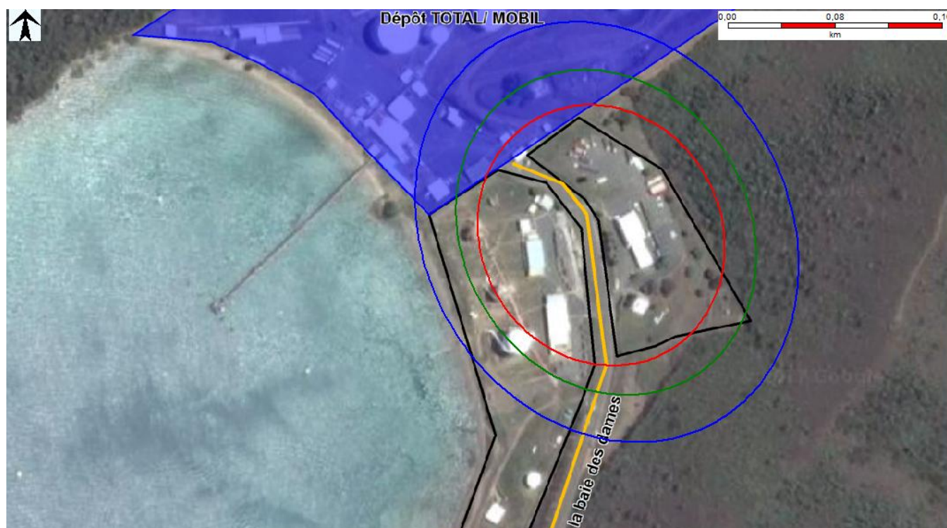
Figure 48 : Cartographie des zones d'effets thermiques du jet enflammé pour la perte de confinement de la ligne de soutirage des sphères
