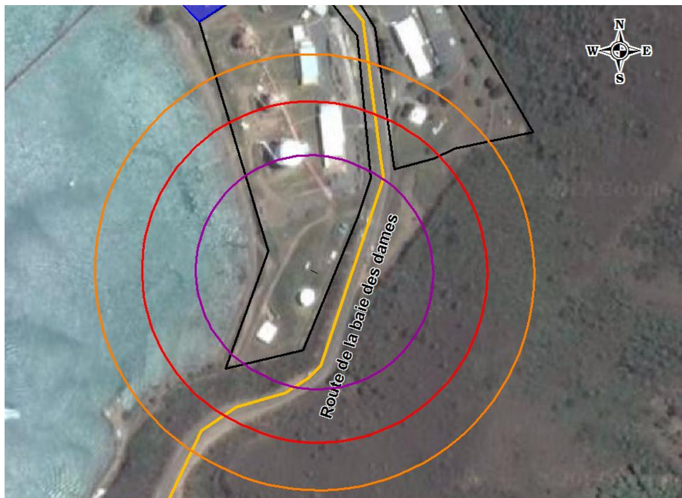
Figure 61 : Cartographie des zones d'effets thermiques pour le BLEVE/ rupture camion au niveau de la zone d'épreuve
