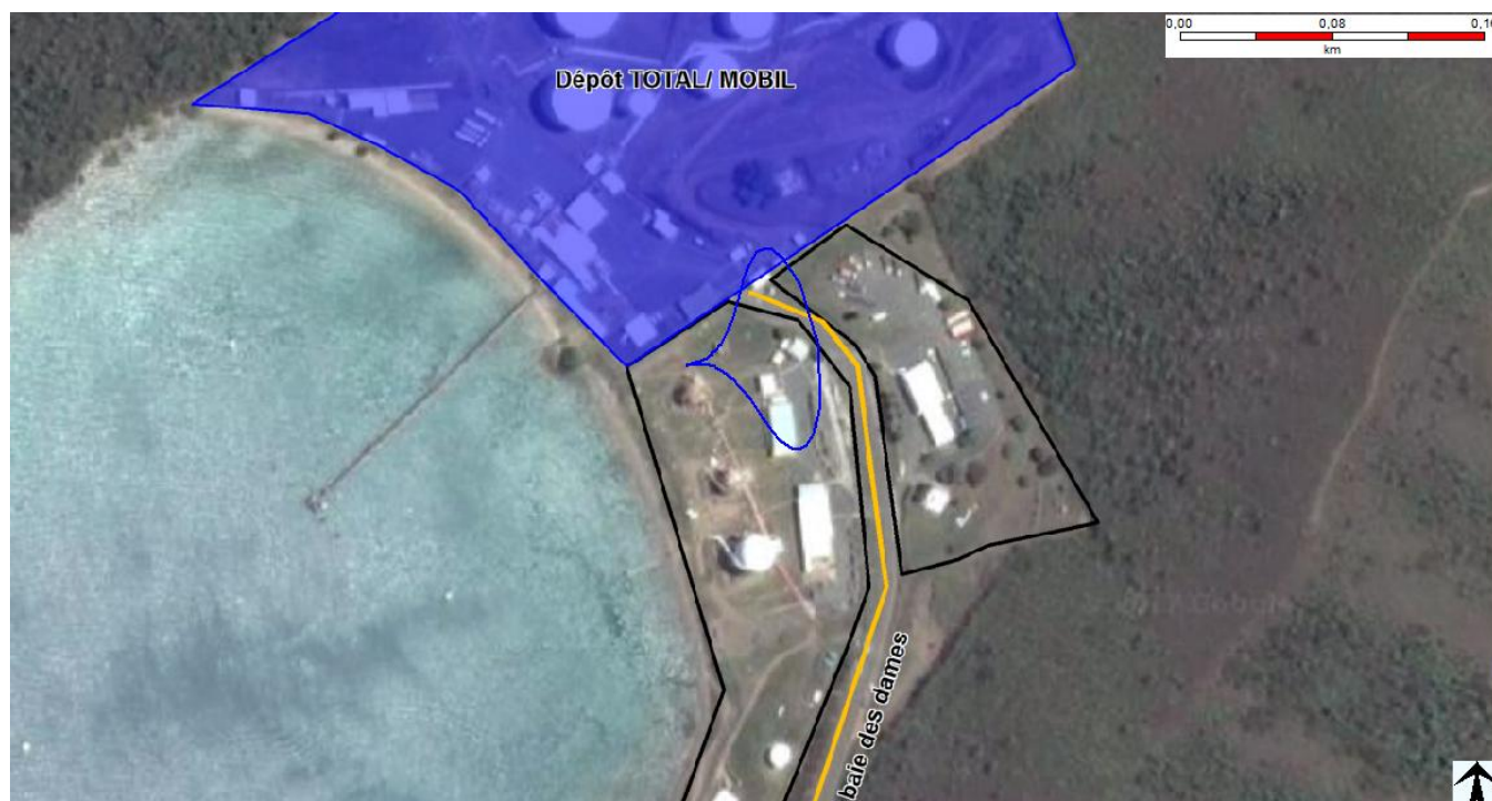
Figure 34 : Cartographie des zones d'effets thermiques du flash fire pour la perte de confinement du flexible de déchargement navire
