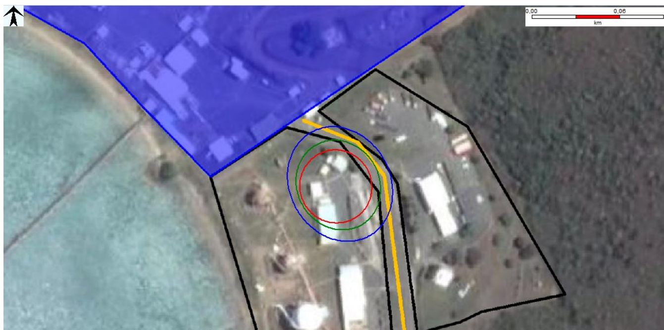
Figure 58 : Cartographie des zones d'effets thermiques du jet enflammé pour la perte de confinement du flexible de chargement
