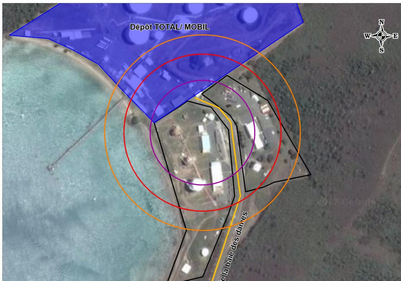
Figure 55 : Cartographie des zones d'effets thermiques pour le BLEVE/ rupture camion au poste de chargement
