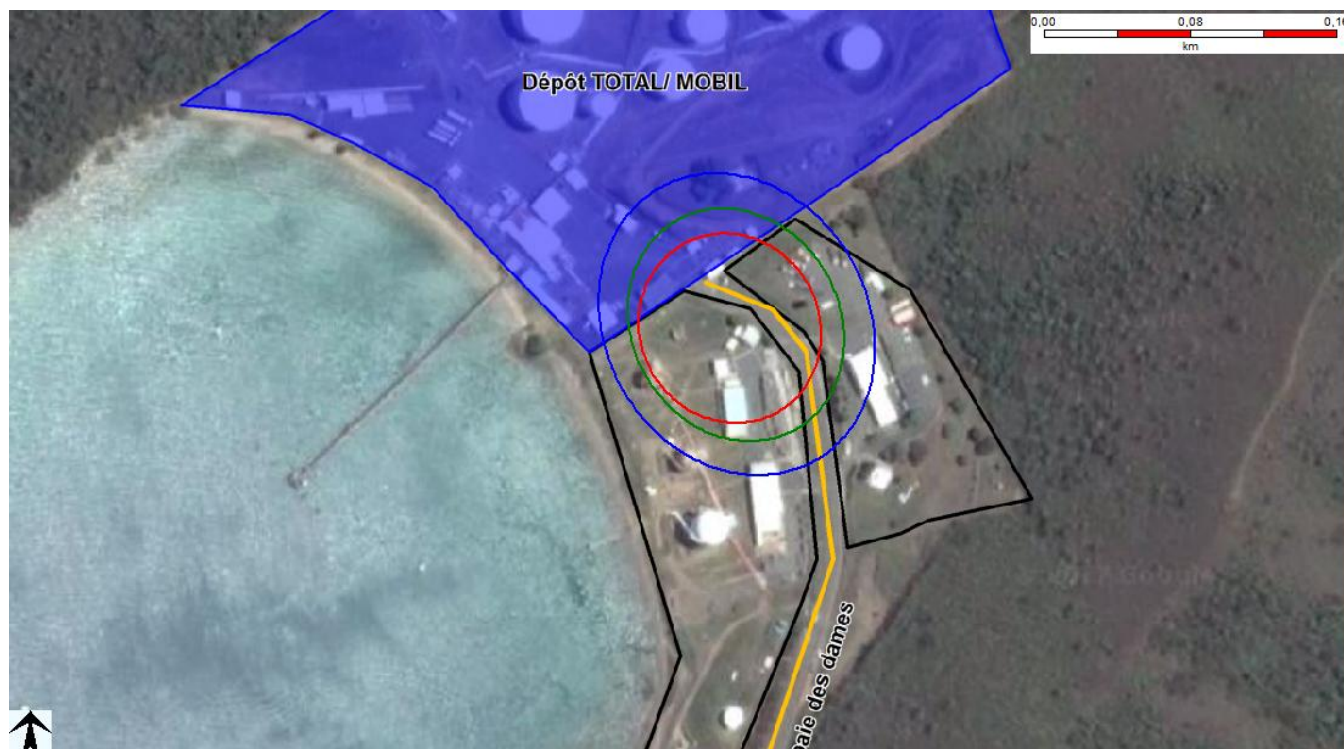
Figure 43 : Cartographie des zones d'effets thermique du jet enflammé pour la perte de confinement de la ligne de purge des sphères
