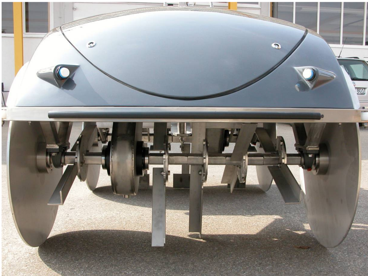
Outils de scarification du SANGLIER ÉLECTRIQUE® (configuration standard – modifications possibles)
