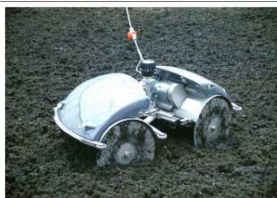
SANGLIER ELECTRIQUE® pendant le travail dans des boues déshydratées.
