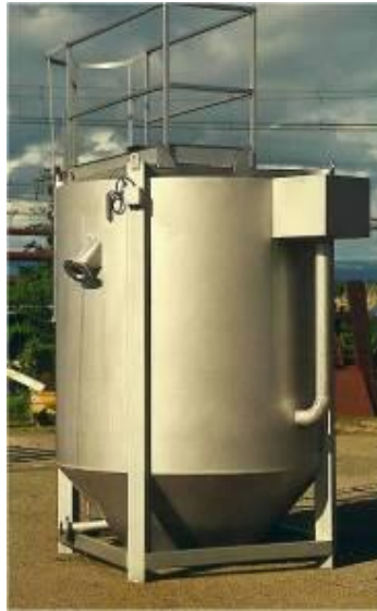
Vue d'un dégraisseur / dessableur
