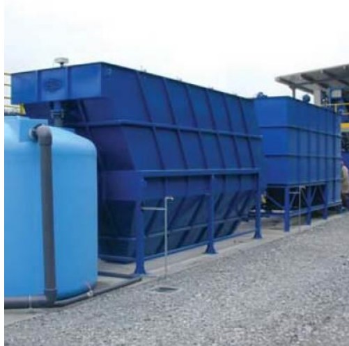
Exemple de décanteur lamellaire
