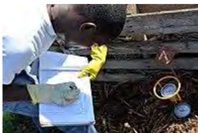
Relevé des températures de compostage par thermomètre de couche dans une installation de Port-au-Prince, Haïti.
