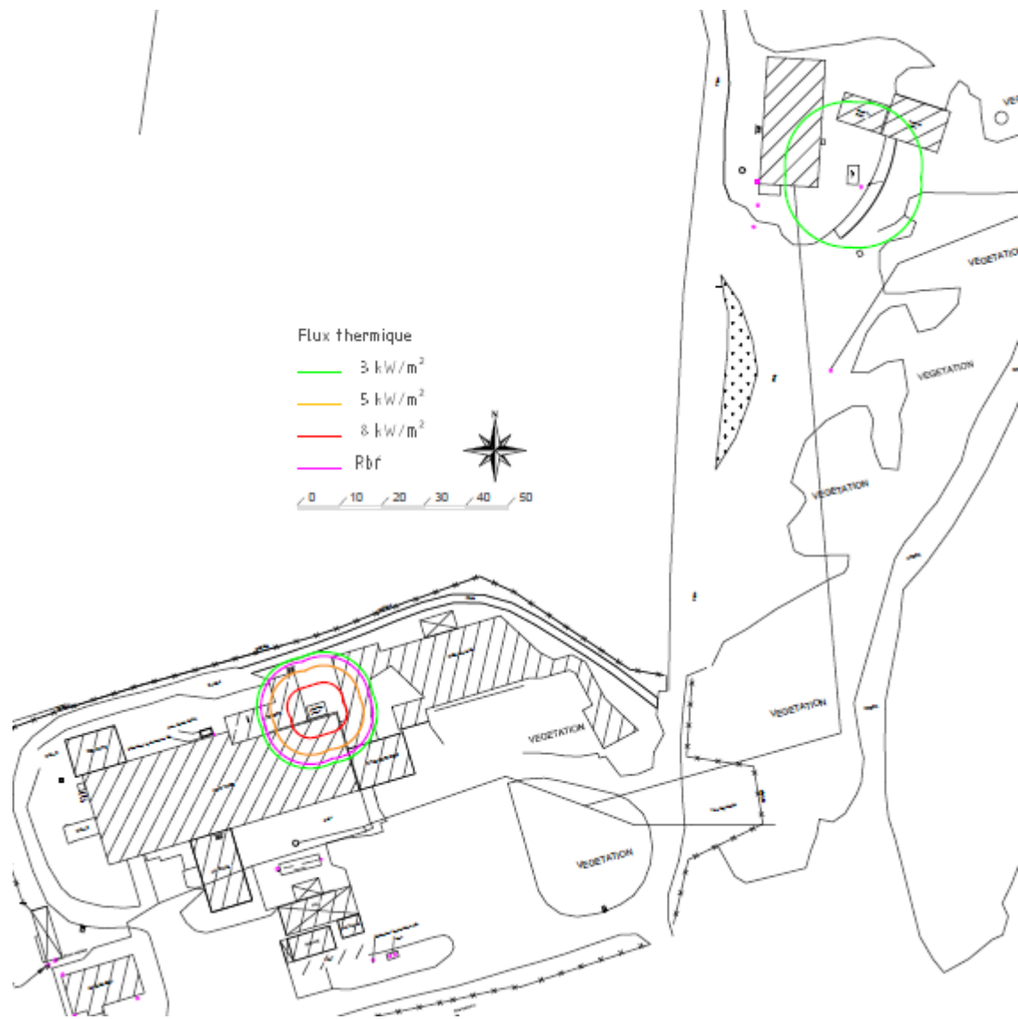
Figure 2 : Zone des flux thermiques
