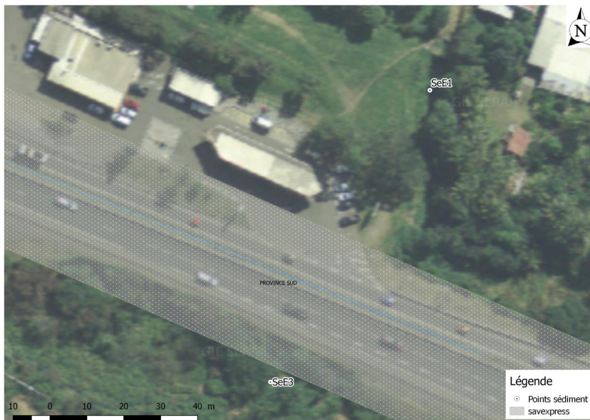
Figure 29 : Localisation des points de prélèvement de sédiment dans le fossé
