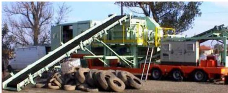
*Exemple de broyeur mobile pour pneus*
