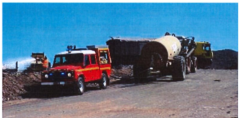
Figure 17 : Véhicule de Première Intervention (VPI) alimenté par la tonne à eau et le tracteur
