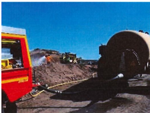
Figure 17 : Véhicule de Première Intervention (VPI) alimenté par la tonne à eau et le tracteur
