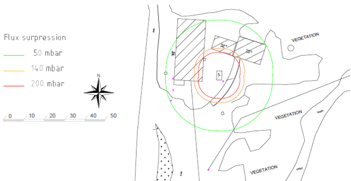
Figure 34 : Zone des effets de pression d'une explosion d'un réservoir de gazole de 10 m 3
