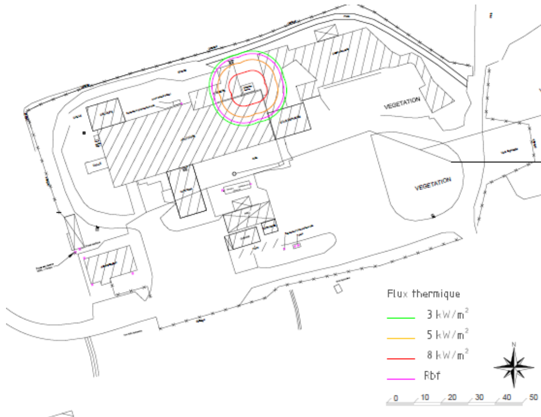
Figure 36 : Zone des effets thermiques du scénario de BLEVE
