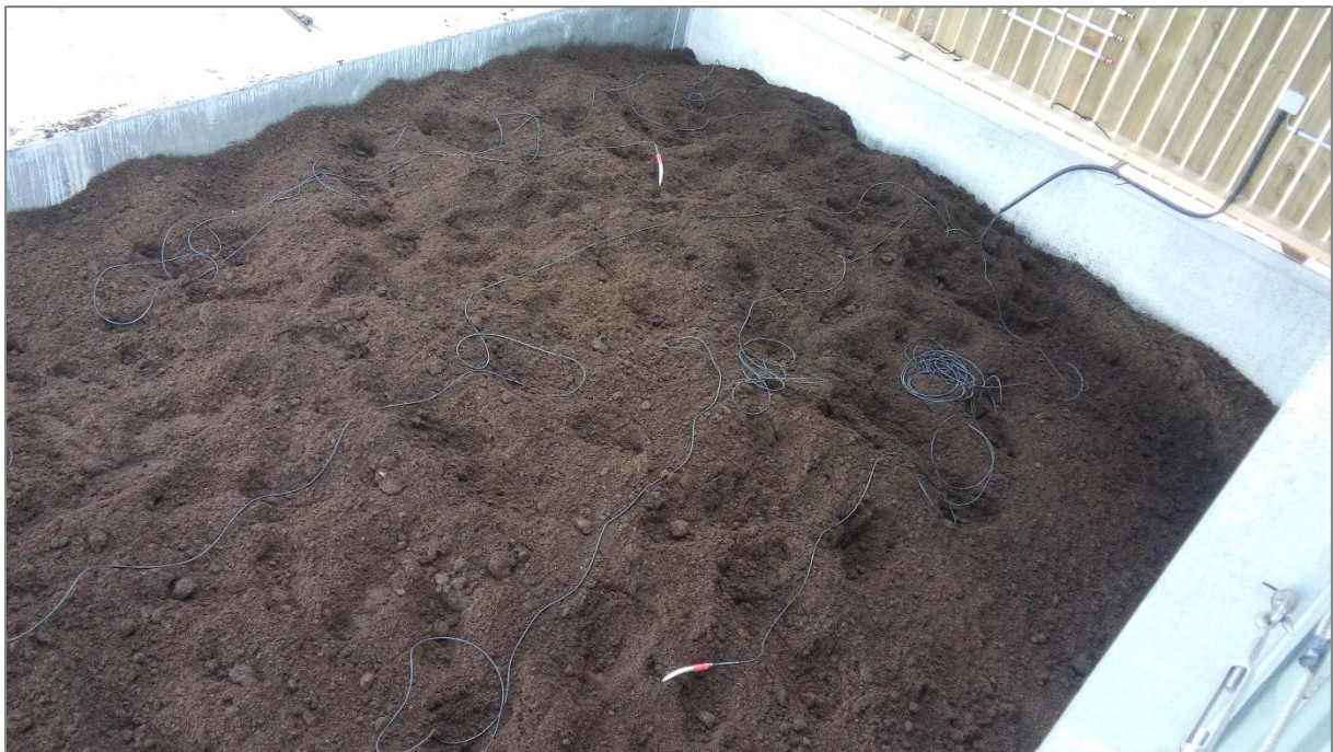
Figure 15 : Positionnement des sondes dans un casier
