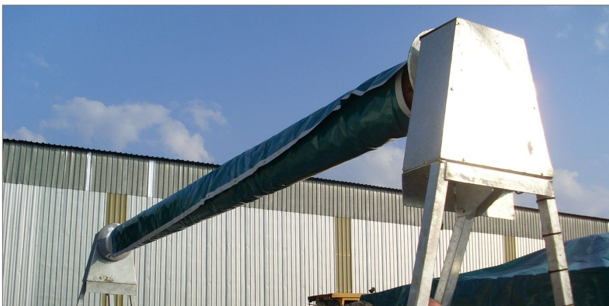
Figure 12 : Enrouleur avec bâche enroulée
