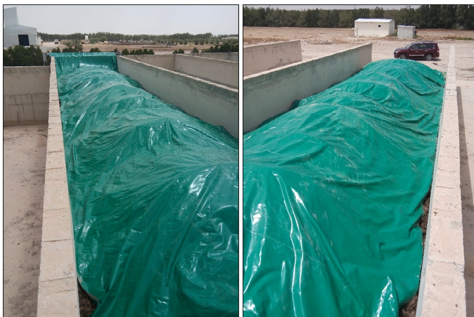
Figure 1 : Zones de fermentation couvertes par bâches
